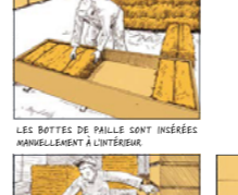
LES BOTTES DE PAILLE SONT INSÉRÉES MARVELLEMENT À L'INTÉRIEUR.
