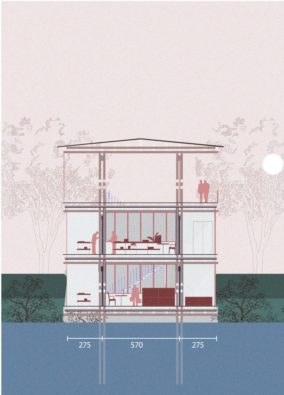
Coupe transversale de la loge, son ouverture vers le Sud Ouest, et l'accès au sol naturel au centre
