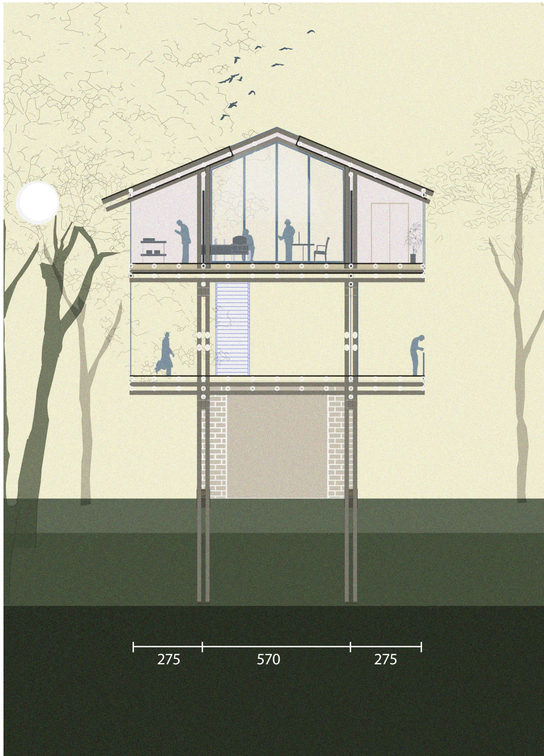
Coupe transversale de la loge, et de son espace central, et son ouverture zénithale.
